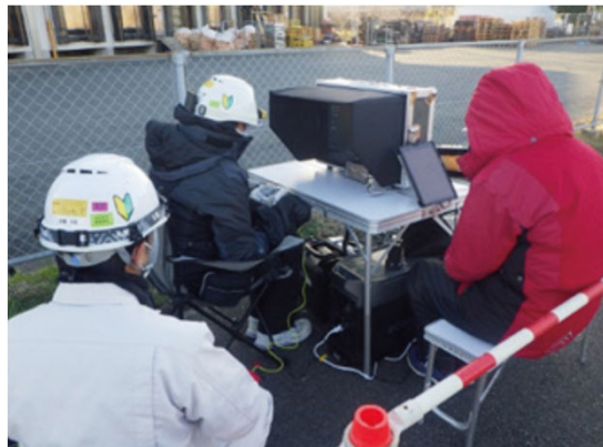
水中ドローンを活用した機能診断調査(福岡導水)
