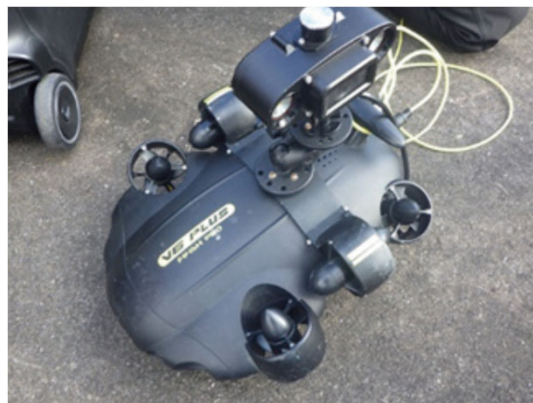
水中ドローンを活用した機能診断調査(福岡導水)
