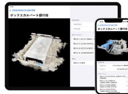
ボックスカルバート計測データ
