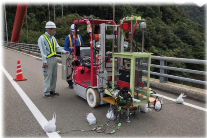
SIVEを用いた衝撃載荷試験の実施状況
