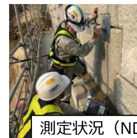
超音波探傷の例 (橋梁点検)
