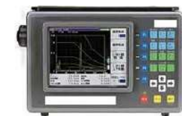
超音波探傷の例 (橋梁点検)
