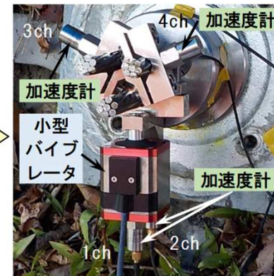
鋼線数の違いによる振動法の測定方法模式図
