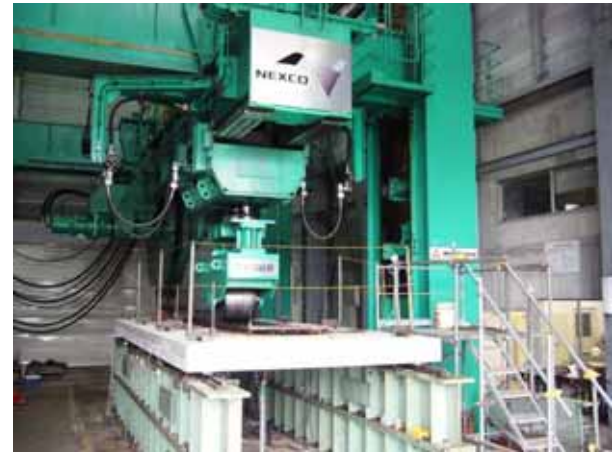
輪荷重移動载荷試験機 (新東名の橋梁設計に大活躍)
