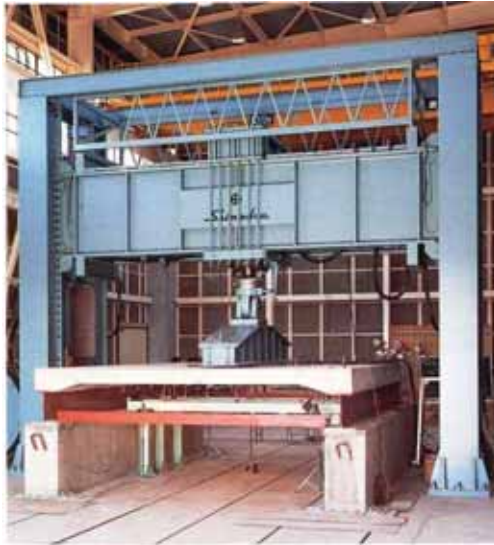
構造物疲労载荷試験機 (東名の橋梁設計に大活躍)
