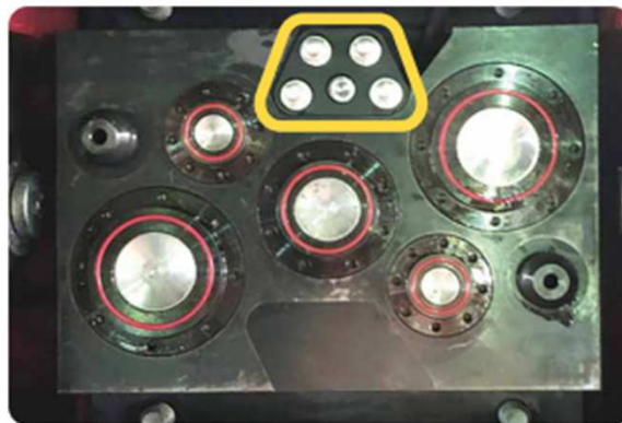
林業用電磁弁操作アタッチメントなどに対応する7芯タイプ
