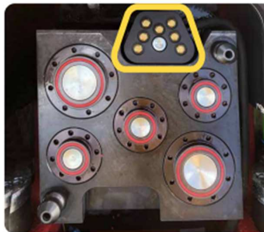
林業用電磁弁操作アタッチメントなどに対応する7芯タイプ
