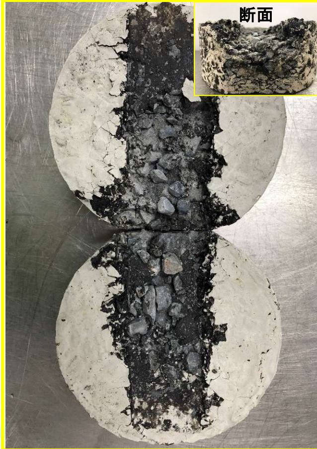
半たわみ性舗装
