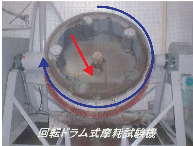
写真-1 回転ドラム式摩耗試験
