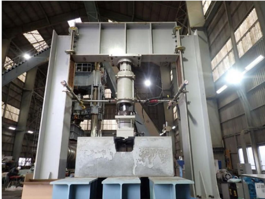
写真 3.1 500kN 疲労試験機
