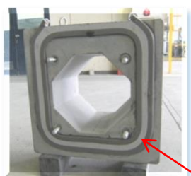
供試体の断面 (写真は 注入工法 )
