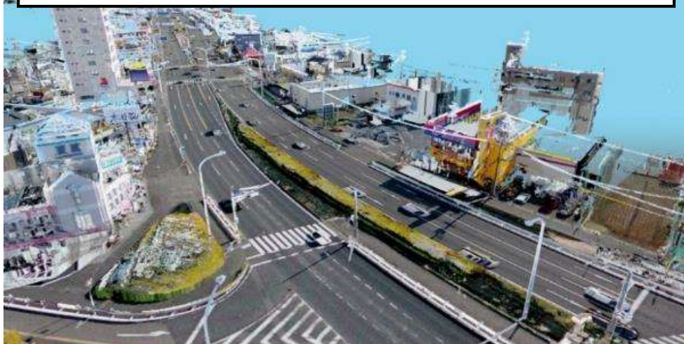
デジタルカメラと点群を関連付けてカラー表示した例
