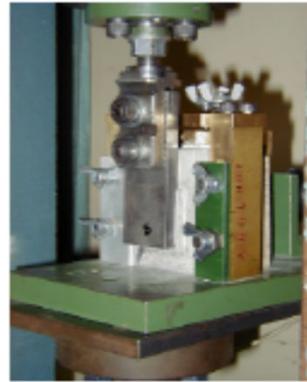
写真2 治具取付状態
