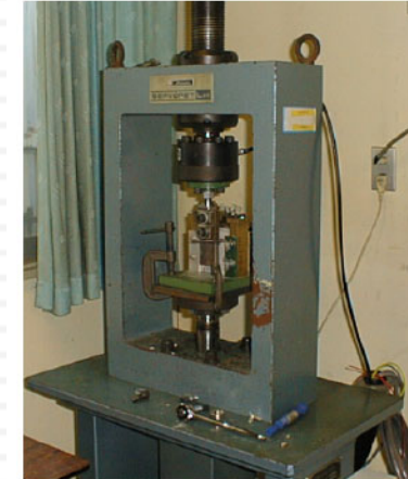
写真3 疲労試験機 (島津製作所サーボベトラボ)
