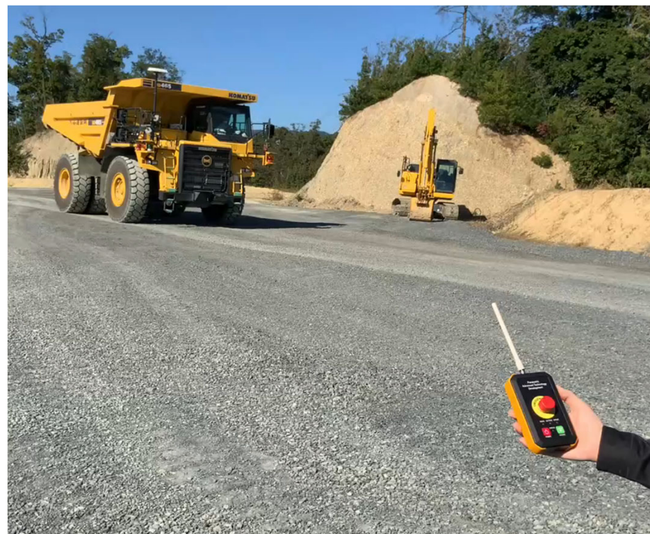
遠隔非常停止状況 別無線システムによる緊急時対応
