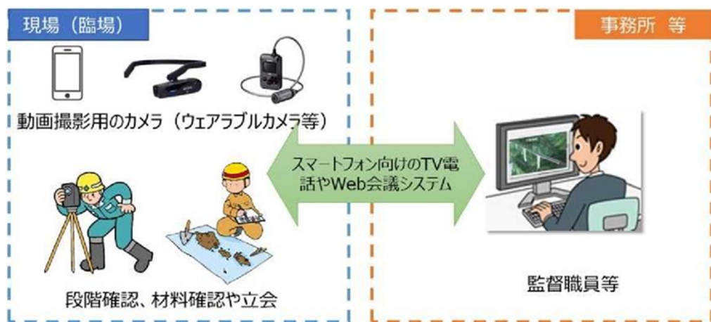
遠隔臨場 ICT活用工事
