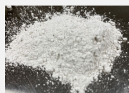
高炉スラグ (鉄鋼副産物)
