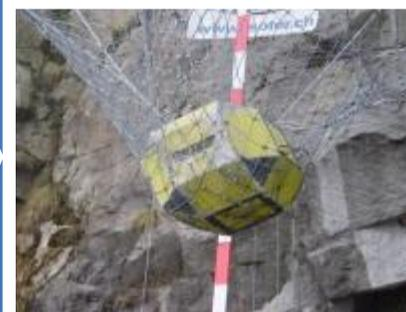
補修したネットで再度捕捉
