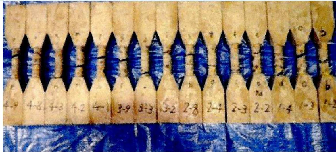
25mm コア引張供試体の破壊状況(全体)
