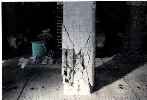
**1** せん断破壊試験後、補修前状況
