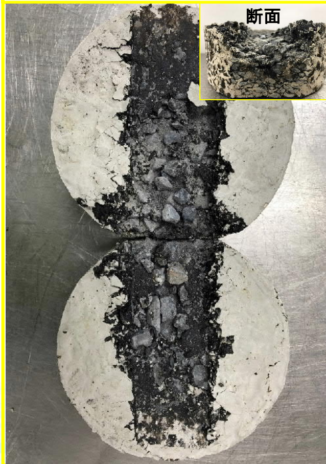
半たわみ性舗装
