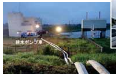
排水ポンプ車による排水活動の状況 (坂戸市 飯盛川周辺)
