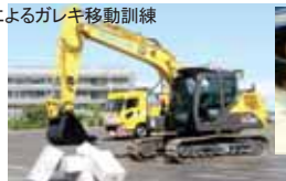
■バックホウ遠隔操作によるガレキ移動訓練
