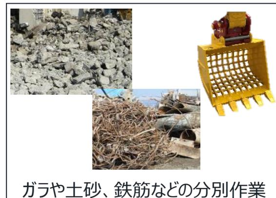
解体工事の作業工程によりさまざまな油圧アタッチメントが使用される
