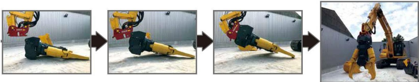
油圧ショベル用油圧式クイックカプラによるアタッチメントの着脱風景
