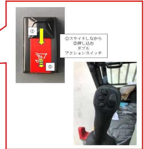
オペレーター人がCAB内のスイッチと油圧ショベルの操作で着脱可能
