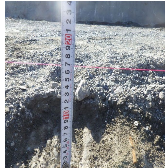
(⑦-3：左岸側 垂直壁下流肩の摩耗量測定状況)
