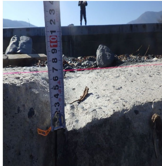
(⑦-2：中央側 垂直壁下流肩の摩耗量測定状況)
