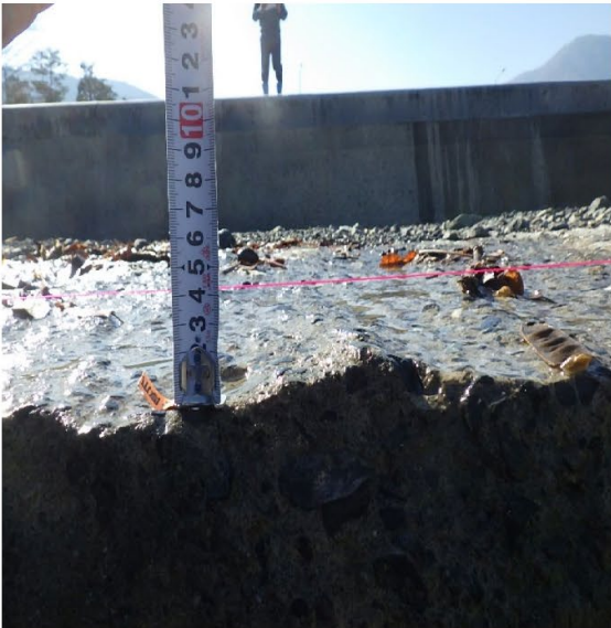
(⑦-1：右岸側 垂直壁下流肩の摩耗量測定状況)
