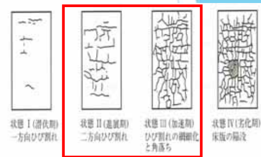
図4.7.3-1 鉄筋コンクリート床版の下面のひび割れと劣化状態
