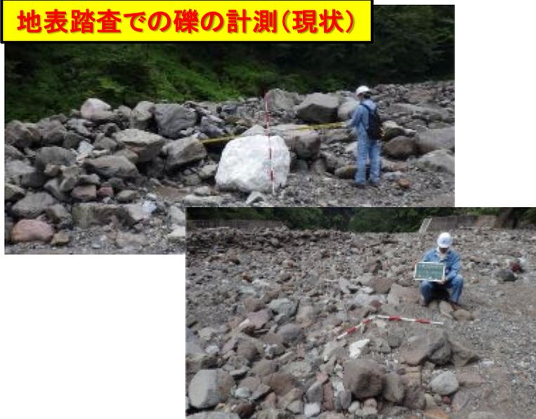
**多量の礫が堆積する現場の場合、最大礫径（D95）を調査することは地表（作業者）の目線では見落としがあり精度が劣る**
