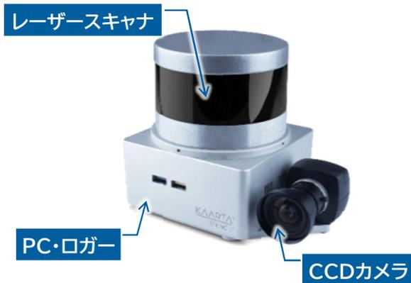
◀ ハンディ型レーザー計測システム ▶
