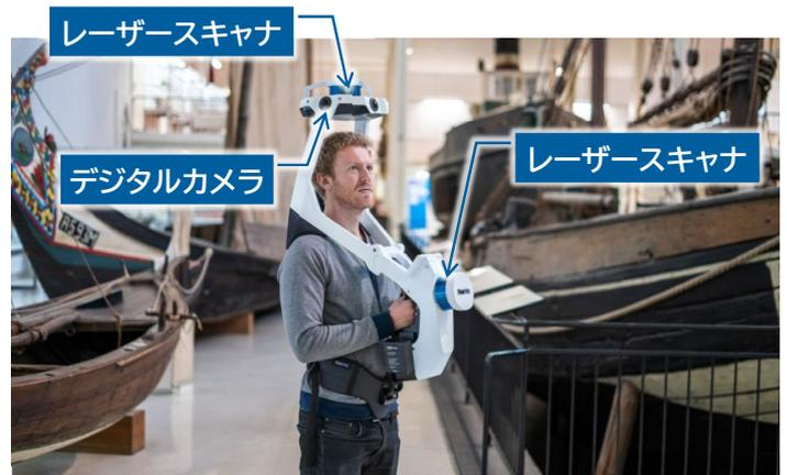
◀ ウェアラブル型レーザー計測システム ▶
