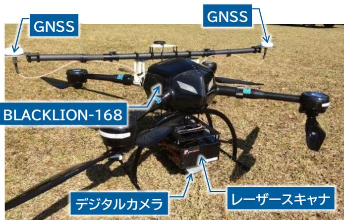
◀ UAVレーザー計測システム(LAP) ▶
