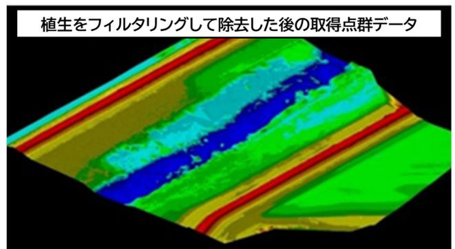
植生をフィルタリングして除去した後の取得点群データ
