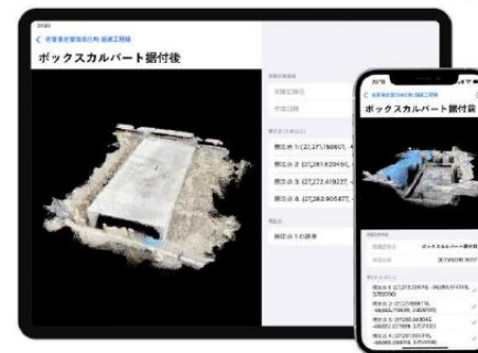
ボックスカルバート計測データ
