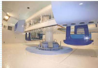
遠心模型実験装置の概念図
