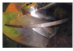
羽根車側面に摺動痕
