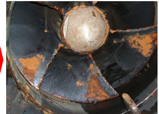
点検の結果、羽根車が摩耗していることがわかりました。
