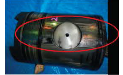
ピストン損傷
