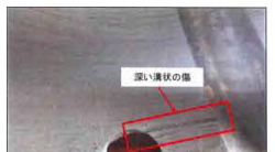
ポンプ軸受内径側に溝状傷
