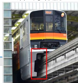
モルール車両からの落雪事故防止
