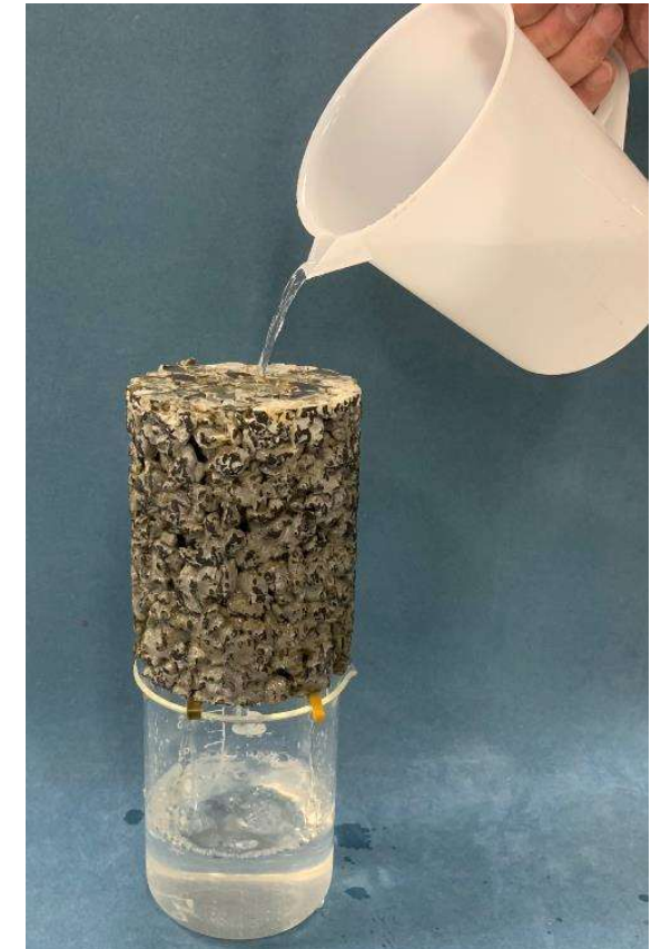
透水性地盤改良体 k=10^{-1}\text{cm/s} 安藤ハザマ特許技術
