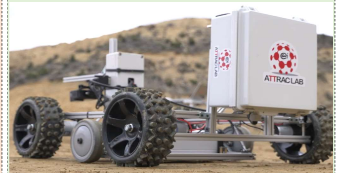
乾燥密度・含水比の取得 【自走式散乱型RIロボット】
