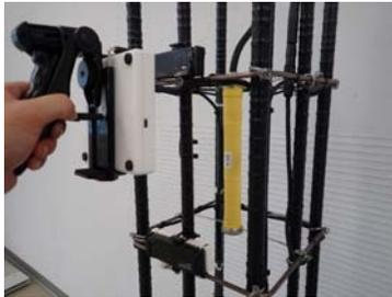
ひずみセンサ取付け状況
