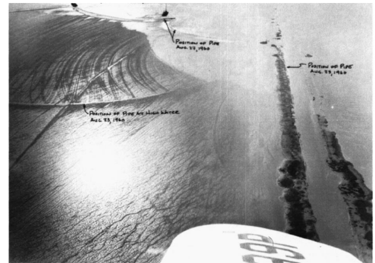
高波による海底地盤災害 (埋設パイプの浮上)
