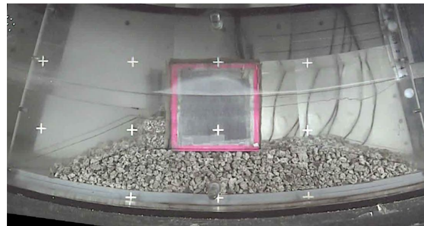
(d) 津波対策:腹付工((ユニット小))
