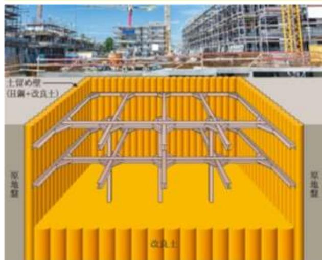
— 掘削底盤の強化 —
