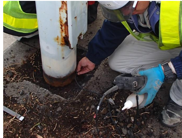
超音波肉厚測定機による測定
