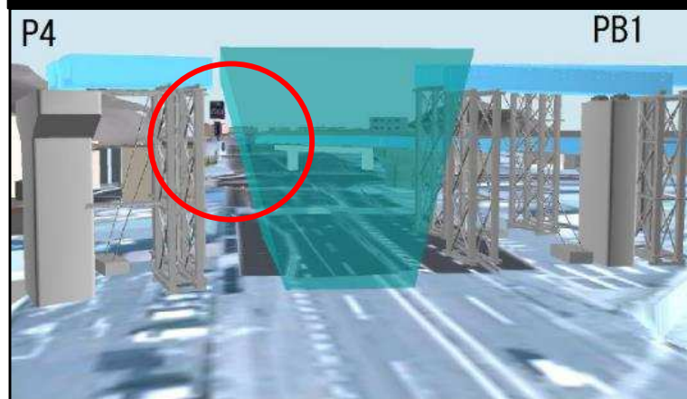
施工条件の確認(架設時の俯角確認)
