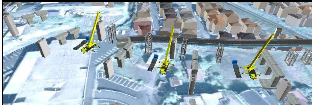
施工条件の確認(重機配置の検討)
