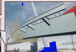
VR架設シミュレーション
