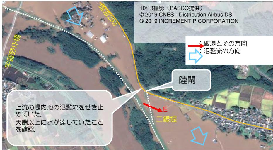
図2.5.5 二線堤の破堤状況
