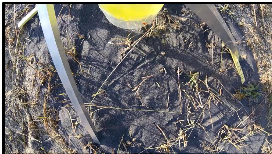
透水係数 1.34 \times 10^{-5} \text{m/sec} (現地実験後、室内透水試験を実施)
