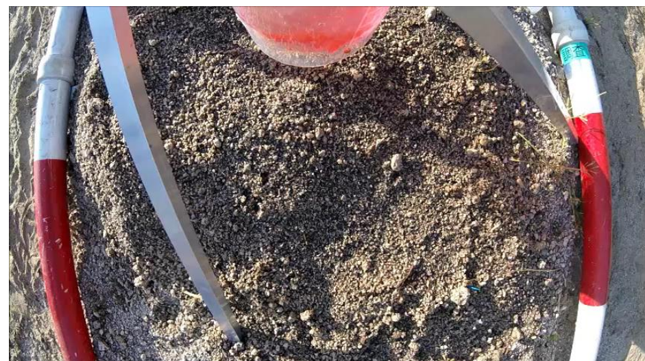
透水係数 6.31 \times 10^{-4} \text{m/sec} (現地実験後、室内透水試験を実施)
