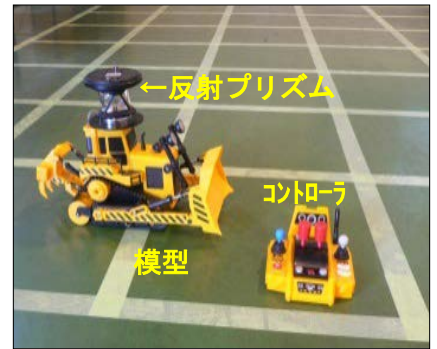
反射プリズム搭載した 模型
