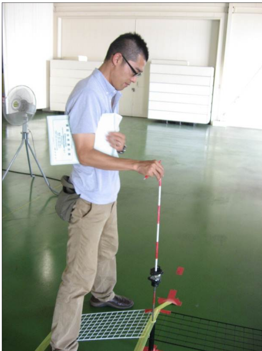
反射プリズムの気泡を見ながら水平取り
